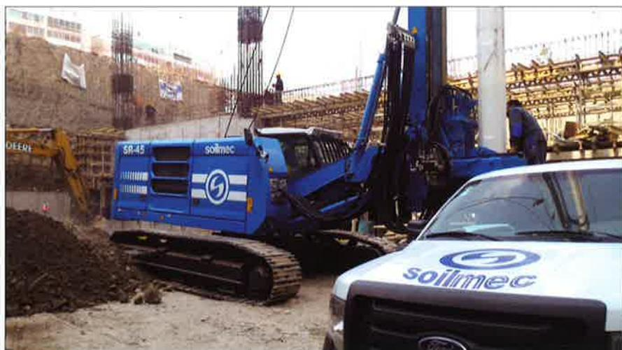
La torretta della perforatrice idraulica alloggia un motore Cummins QSB6.7, disponibile con motorizzazioni Tier 3, Tier 4i e Tier4f (in uscita), con alimentazione turbo intercooler aria/aria
