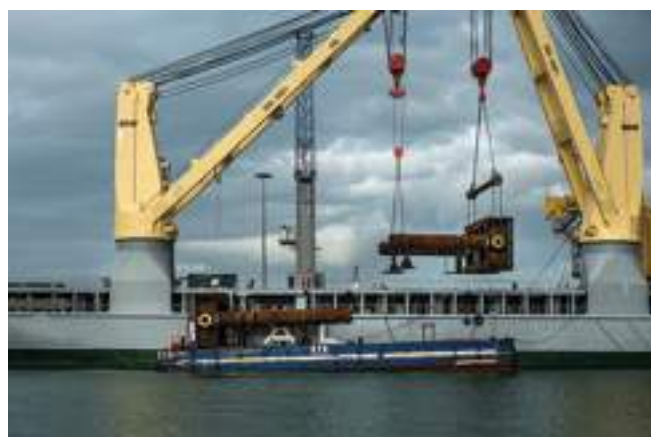
Alcune sezioni dei pali di fondazione nel capannone della Gas and Heat e operazioni d'imbarco sulla nave Heavy Lift Svenja nel porto di Livorno
