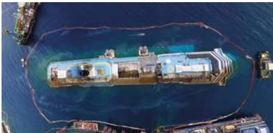
Costa Concordia a operazione "parbuckling" quasi terminata
