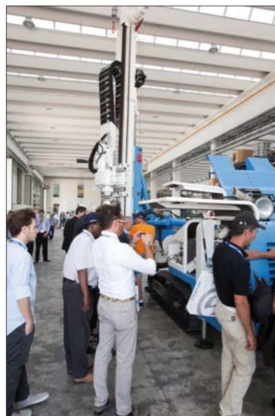
Le contenute dimensioni della macchina base, unitamente alla geometria dell'antenna e alla versatilità del cinematismo, fanno della SM-4 un prodotto ideale per chi necessita di operare in spazi ristretti e di difficile accesso, all'interno di edifici e di gallerie di piccole dimensioni.
