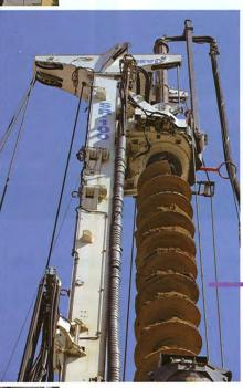
Con un peso operativo di circa 150 t, la SR-100 è l'ammiraglia Soilmec. Una macchina multifunzionale progettata pensando alle differenti esigenze di cantiere e per essere equipaggiata in varie tecnologie e far fronte a qualsiasi richiesta di cantiere. Alimentata da un motore Deutz TCD2015 V08 in grado di erogare una potenza di 480 KW, la SR-100 è dotata di una testa rotary con cambio che esprime una coppia massima nominale di 452 kNm e di un argano principale con un tiro pari a 370 kN.
