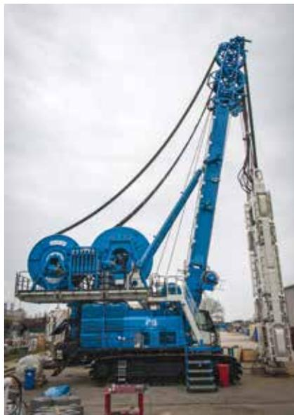
LA NUOVA IDROFRESA SOILMEC SC-135 TIGER È PROGETTATA PER OTTENERE LE PIÙ ALTE PRESTAZIONI NELLA REALIZZAZIONE DI DIAFRAMMI. IN VERSIONE STANDARD RAGGIUNGE I 100 M DI PROFONDITÀ, MA APPOSITAMENTE ALLESTITA PUÒ ARRIVARE ANCHE A 120 E 150 M
